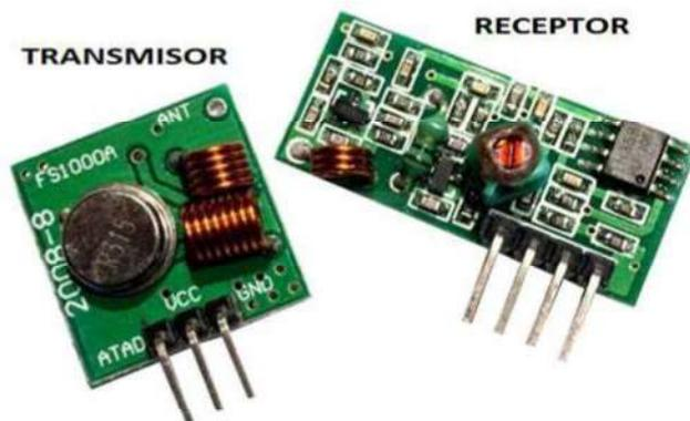
En la imagen se muestran los módulos RF. El módulo más pequeño es el transmisor TX, mientras que el dispositivo de forma alargada es el receptor RX.
