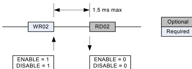
**Figure 9. Powerdown Timing**
